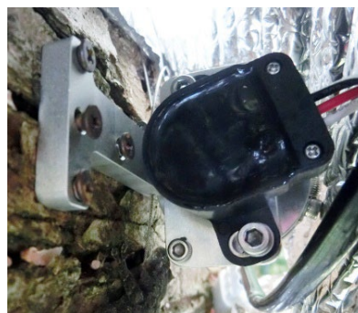
写真 2-2-5 自記記録型デンドロメーター 幹の胸高部位でワイヤーを一周させ、その伸縮を記録する。
