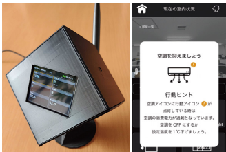
BI-Techオフィス省エネシステム(◆) 室内環境計測と行動変容促進による省エネ効果検証の実証実験
