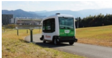
運転席のないバスの自動試行実証実験(●) 自動運転バス走行と通信ネットワーク・サービス基盤の技術開発に関する実証実験
