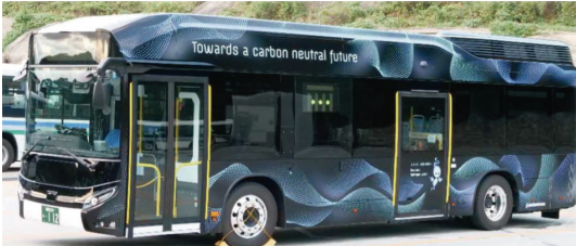
水素燃料電池バス(◆、◎) ゼロエミッション電源(発電時にCO2を排出しない電源)を用いた水素社会地域モデルの構築に関わる実証実験
