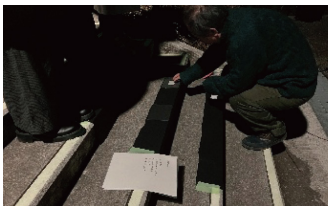
夜盲症を基点にした蓄光階段(★) 夜盲症の人による夜間の階段の識別性向上に関する実証実験
